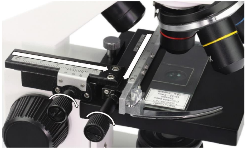
Fig. Utilización del accesorio de platina en cruz disponible por separado (ref. 62506).
